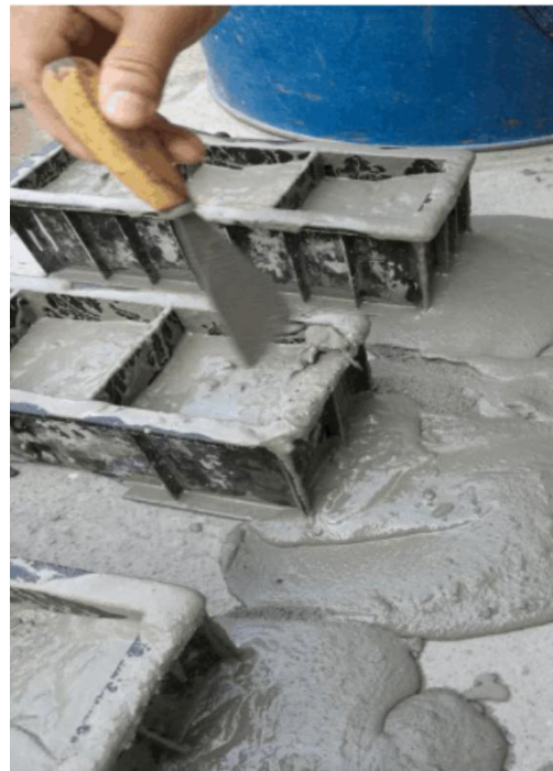
(除去部分浮浆)
